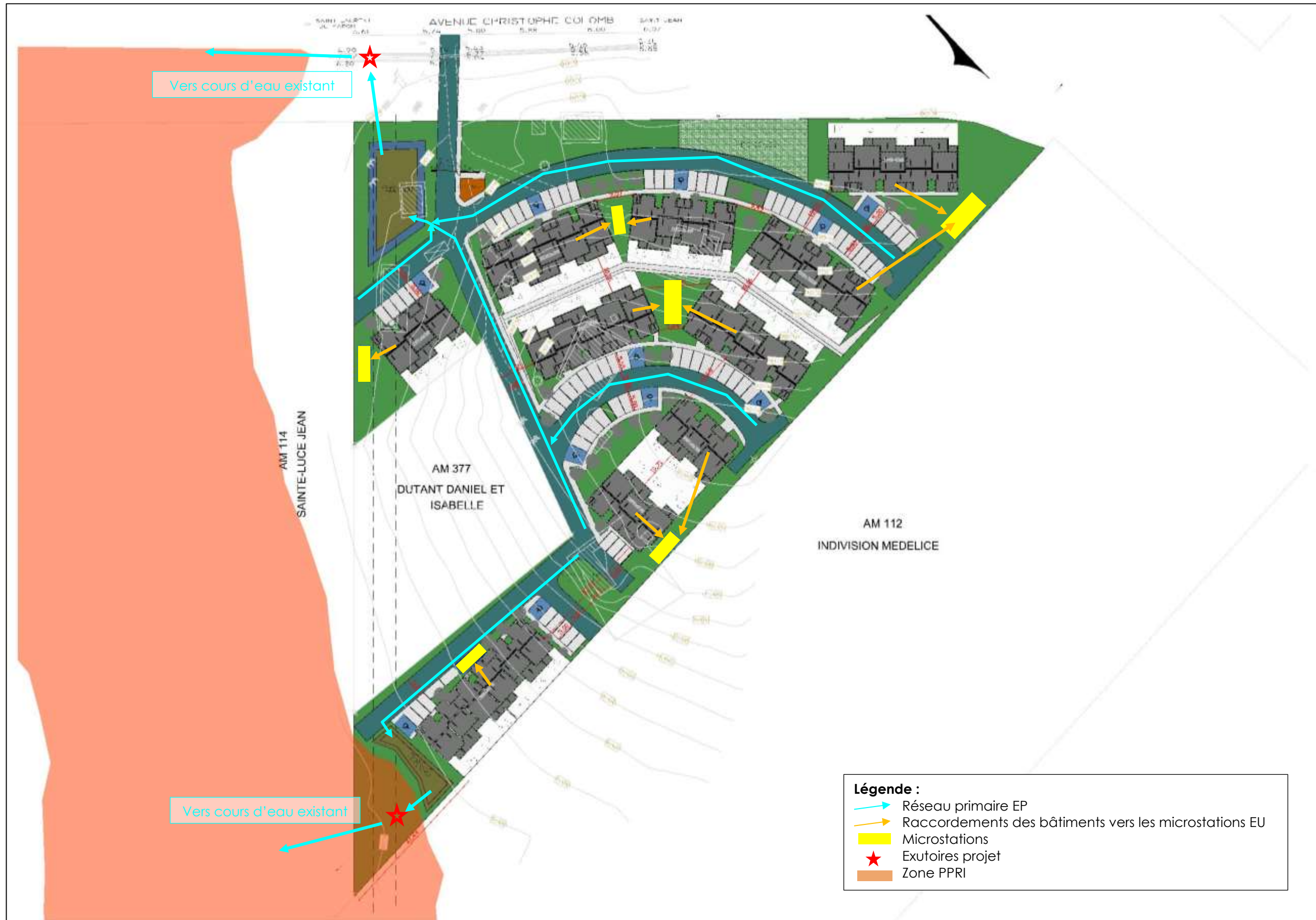
Figure 4 : Schéma réseau EP et EU
